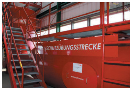
Simulatorul de 14 metri lungime de la centrul nostru de instruire permite operatorilor să exerseze folosind RPE-ul într-o varietate de medii
